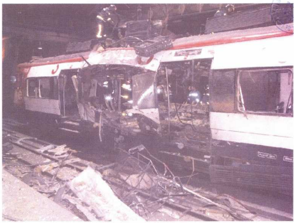
VISTA DE LOS EFECTOS DE LA EXPLOSIÓN EN EL COSTADO IZQUIERDO DEL VAGÓN
