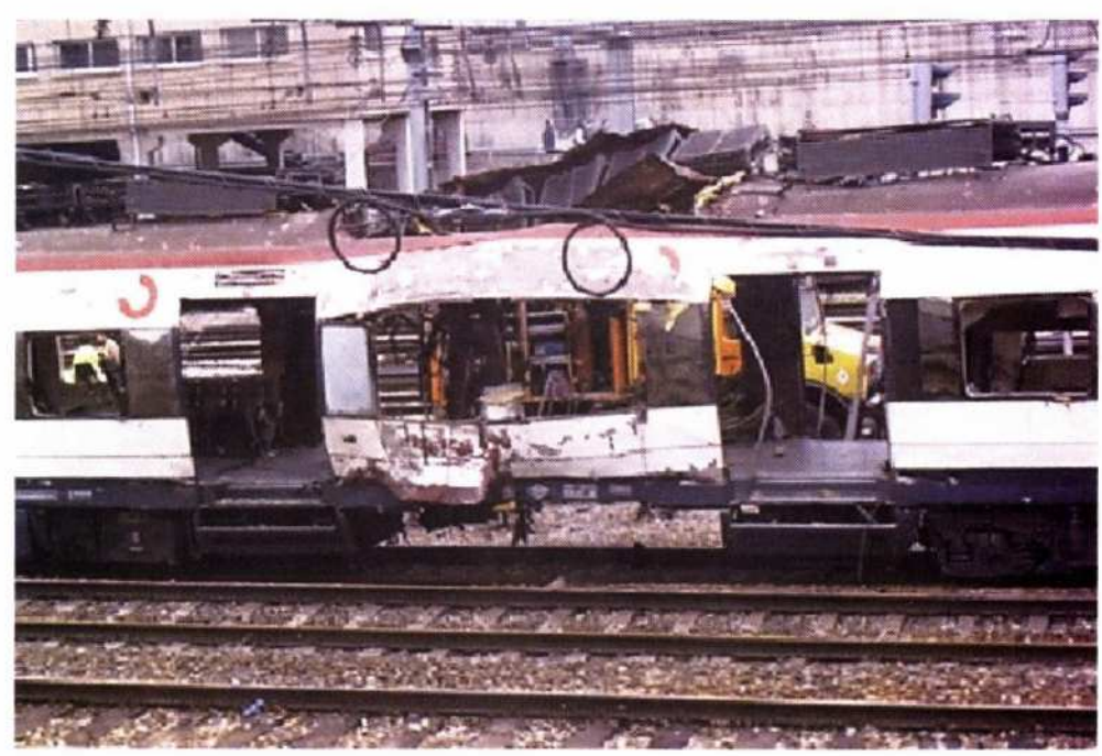
VISTA DE LOS EFECTOS DE LA EXPLOSIÓN EN EL COSTADO DERECHO DEL VAGÓN
