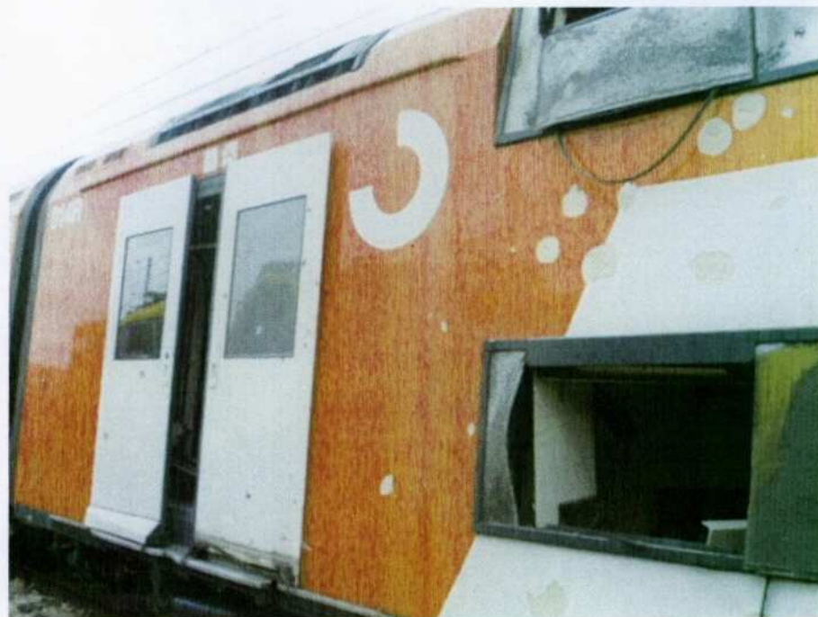
VISTAS DE LOS EFECTOS DE LA METRALLA EN EL LATERAL DEL VAGÓN
